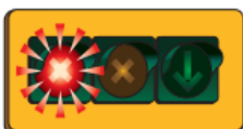
Signal de contrôle : Placé sur les voies pour indiquer celles qui sont ouvertes à la circulation. Ici : ROUGE = ne pas circuler sur la voie de droite.
